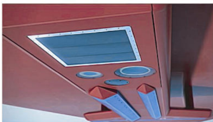
Рис. 5. Размещение антенн МЛЭ, профилографа и лага в гондоле
